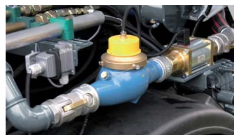
Водовод, дозатор воды
