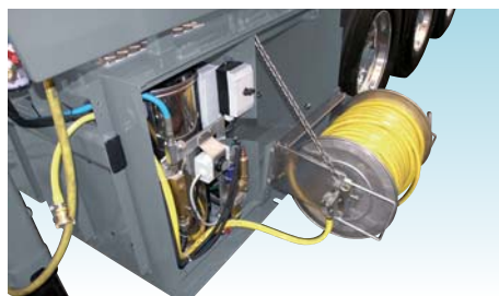
Барaban для водного шланга с гидравлическим приводом и прибор для подогрева воды
